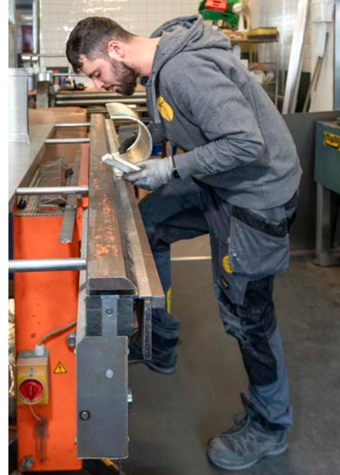
Um ein Rohr herzustellen, biegt Andrea Piceci das Blechteil an der Rundungsmaschine zurecht.
