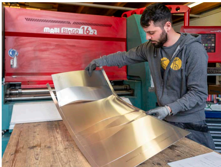
Der Isolierspengler entfernt die überschüssigen Blechteile von der Form, die die CAD-Maschine ausgeschnitten hat.
